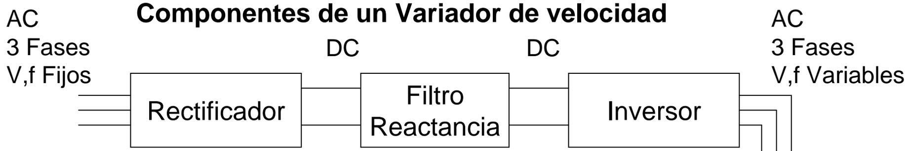
Los variadores de velocidad electrónicos, utilizan técnicas de modulación, para convertir:
